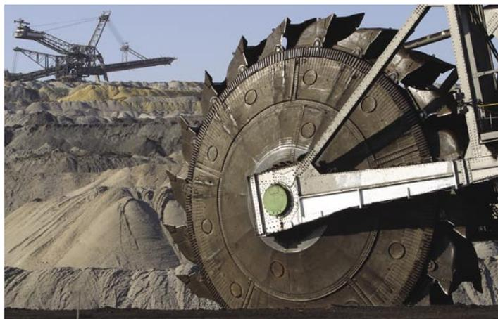
Die Schaufelradbagger des Tagebaus Inden fördern jeweils bis zu 110.000 Kubikmeter Abraum und Kohle pro Tag.
