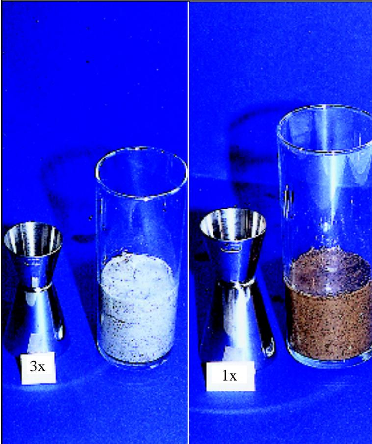
**Versuch 3: Wasserspeicherfähigkeit von verschiedenen Böden****Material: Sand, Lehm, Glaszylinder, Messbecher, Löffel**
