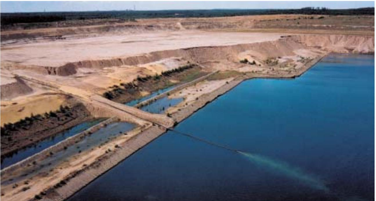
Der Tagebau Greifenhain wird seit Mai 1998 über eine 8 Kilometer lange Leitung mit Fremdwasser geflutet.
