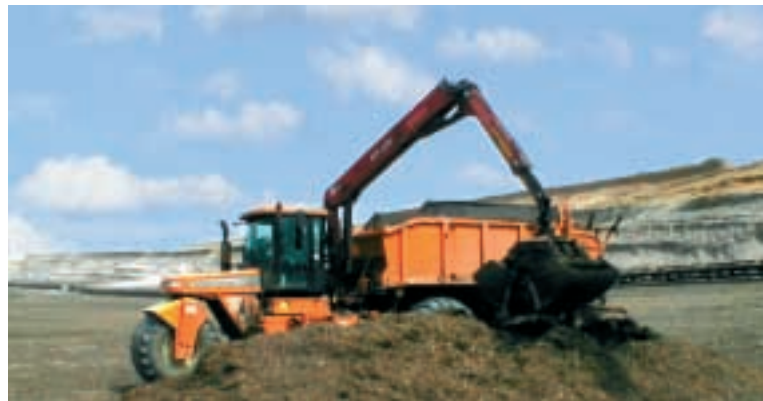
Auftrag von Kompost auf länger freiliegenden Tagebauflächen
