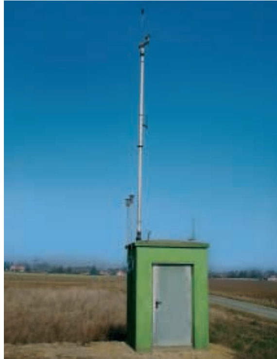
Feinstaub-Messstation von RWE Power bei Elsdorf
