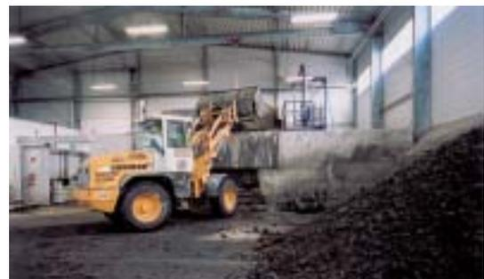
**Klärschlammmitverbrennung** im Kraftwerk Mumsdorf. Seit dem Jahr 2000 wird hier kommunaler Klärschlamm, nachdem er mechanisch entwässert wurde, mitverbrannt. Alle geforderten Emissionsgrenzwerte werden eingehalten. Maximale Mitverbrennungsleistung: 18 t/h.
