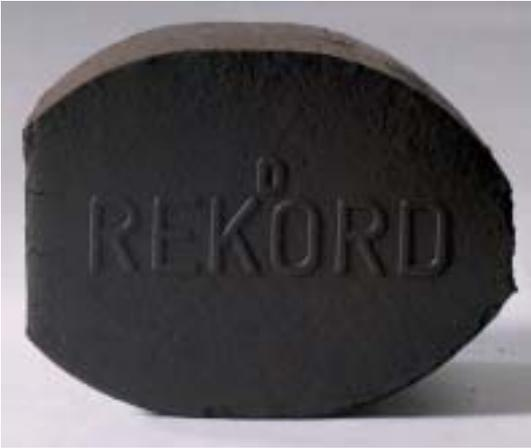
Einen Schritt ins absolute Neuland stellte die Entscheidung zur Einführung des **Additivbriketts** dar. Additivbriketts entstehen durch Beimischung von Kalkmilch und Zusatz von Anthrazitstaub, um die Schwefelemission entsprechend der gesetzlichen Forderungen einzuhalten und gleichzeitig den höheren Heizwert mitteldeutscher Briketts zu erhalten. Kapazität von täglich 1.200 t Briketts.
