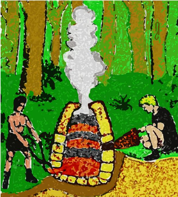
Auf einer fest gestampften Grundfläche wurde der Rennofen errichtet. Seine Lehmwände waren etwa zwanzig cm dick und einen Meter hoch. Sie wurden von einigen Tonröhren zur Lüftung unterbrochen. Die Männer füllten von oben aus mehrere Schichten von Holzkohle und Eisenerzklumpen ein und entzündeten den Ofen. Mit Hilfe eines Blasebalgs blies einer der Männer Luft ins Ofeninnere. Dadurch konnte eine Hitze von 1200 °C erreicht werden. Wenn das Eisenerz fast
