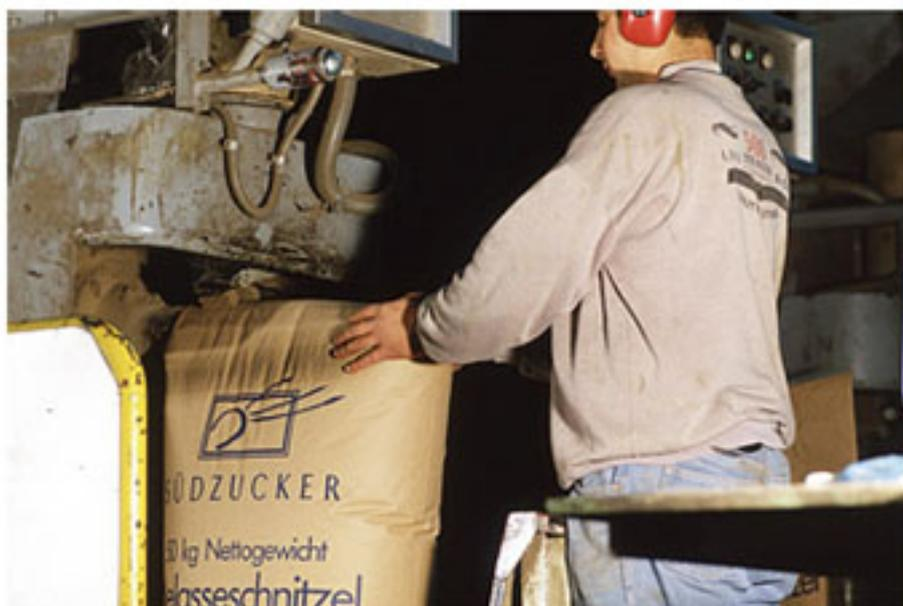
Den abgetrennten Sirup der letzten Kristallisation nennt man *Melasse*. Aufgrund des immer noch hohen Zuckergehalts wird Melasse an das Futtermittel *Rübenschnitzel* angetrocknet.
