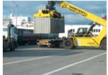
Kraftprotz Reachstaker: 30 Tonnen in der Luft
