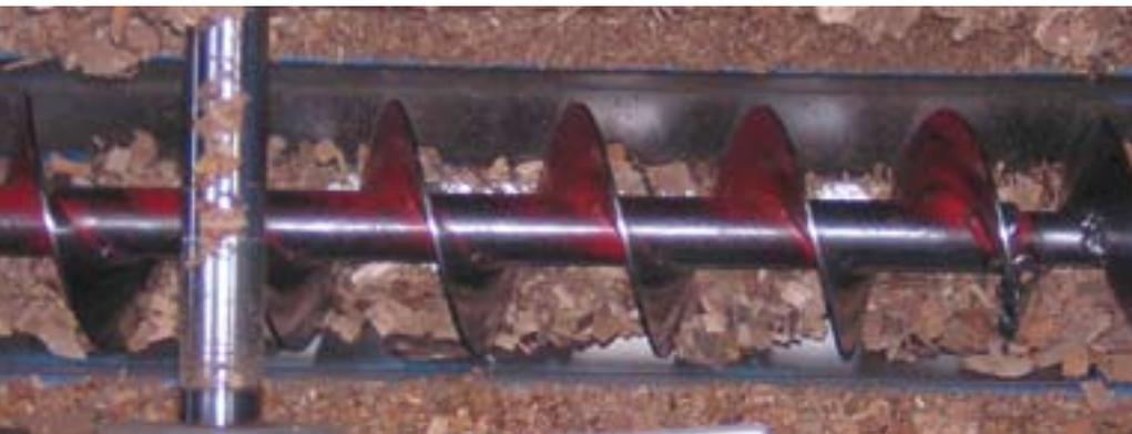
Holz hackschnitzel: Ein Querförderer versorgt den Heizkessel mit Brennstoff
