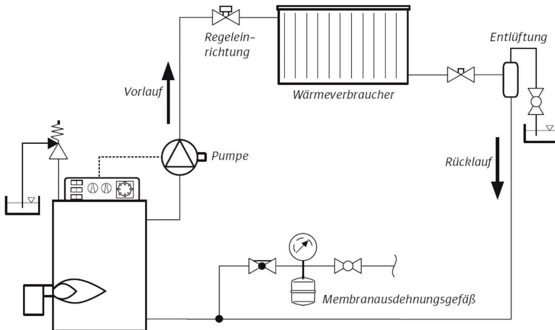
Nach welchem Prinzip arbeitet eine Pumpen-Warmwasserheizung?
