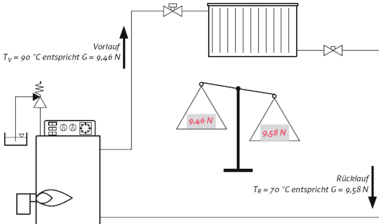
Nach welchem Prinzip arbeitet eine Schwerkraftheizung?
